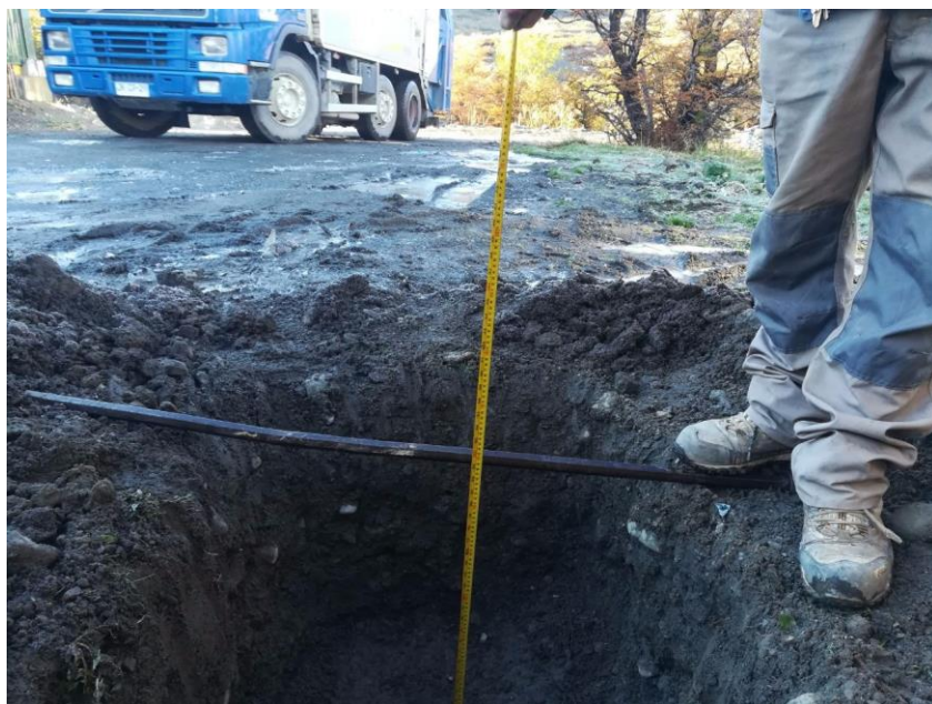
Figura 5. Calicata de 1 m aprox. En sitio adyacente al hecho constatado N°3. No se evidencio presencia de napa subterránea. El examen visual indicaría alto contenido de arenas, lo cual es consistente con los resultados de laboratorio efectuados por la empresa Terra Lab. El suelo se tanto de la calicata como del camino está húmedo producto de las lluvias ocurridas en el los días previos de realizar la calicata.
